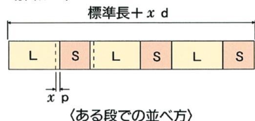
法長5m、半径50m、勾配1:0.5の積ブロックを施工する際の1
